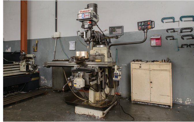
Acima, fresadora ferramenta com capacidade de movimentação de 1000 mm (eixo X), 1000 mm (eixo Y) e 500mm (eixo Z). Abaixo, mandrilhadora com capacidade de usinagem de até 3 toneladas.
